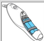
La estación de base se suministra con una batería recargable. Para poder utilizar la función de recarga, el acumulador ha de estar situado en el compartimento para pilas del termómetro.
